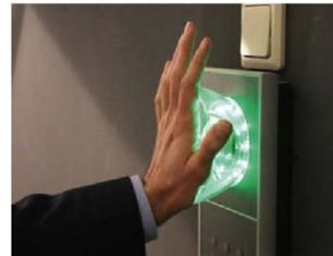
Handvenen-Scanner am Eingang: Das Rechenzentrum wird durch starke Kontrollen vor Zugriffen durch Unbefugte geschützt.
